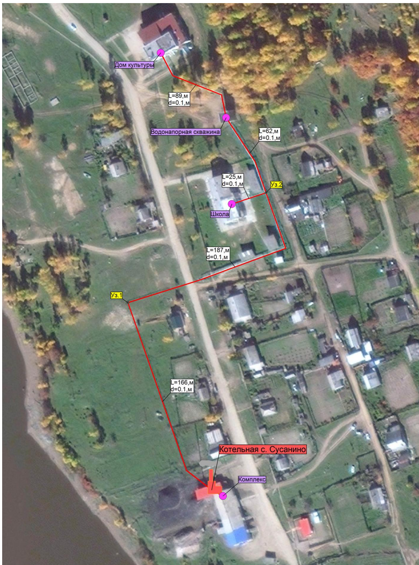
Рис. 1.4 – Схема теплоснабжения муниципального образования «Сусанинское сельское поселение» от котельной с. Сусанино
